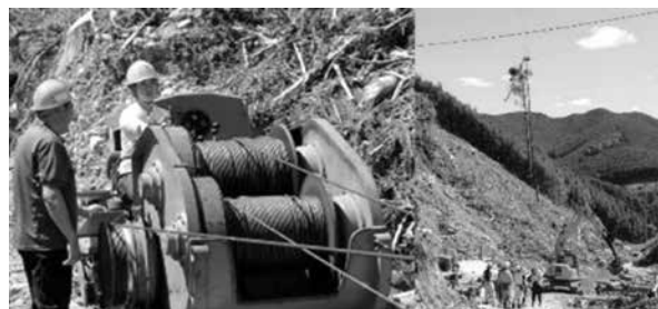
写真-2 大型ウインチによる架線集材
