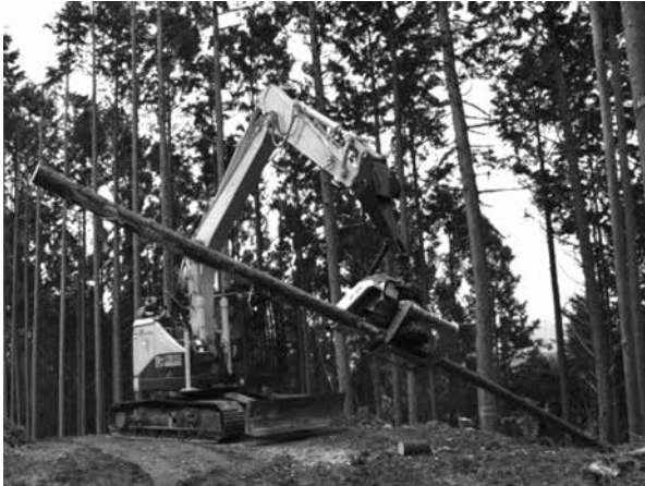
写真-3 プロセッサによる造材
