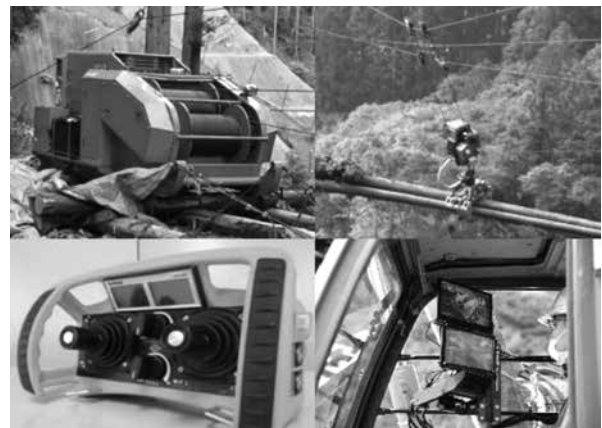
写真-5 遠隔操作式架線集材システム
